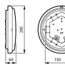
**Caractéristiques Philips Hublot LED Ledinaire WL070V Blanc 20.9W 1700lm - 840 | 285mm - IP65 - DéTECTEUR de mouvement et de lumière**
