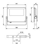
**Caractéristiques Philips Projecteur LED Coreline BVP125 Gris 95W 12000lm 9-41x102D - 740 | IP66 - Asymétrique**
