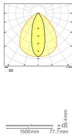
**Caractéristiques Ledvance LED Rail de fixation suspendu Trusys Flex Claire 35W 5800lm 30D - 840 Blanc Froid | Dali Dimmable**
