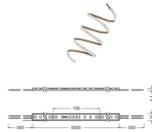
Caractéristiques Ledvance Rubans LED Value 1500 60W 5820lm 24v - 865 | IP66 - 5M/10mm
