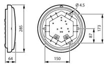
**Technische Daten Philips LED-Wand- und Deckenleuchte Ledinaire WL070V Weiß 20.9W 1700lm - 840 | 285mm - IP65 - Bewegungs- und Lichtsensor**
