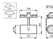
**Technische Daten Philips LED Schienenstrahler Spot Greenspace Maxos Fusion GEN2 ST321S Weiß 19W 2700lm 38D - 830**
