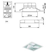
Technische Daten Philips LED Deckenstrahler LuxSpace Quadrat DN572B VLC-E 10.3W 1350lm 80D - 830 | 214mm - Dimmbar - Aluminium Reflektor - Dali Dimmbar
