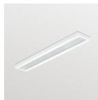
**Technische Daten Philips LED Panel Coreline SM134V 34W 2700lm - 830 | 120x20cm - UGR <22 - Dali Dimmbar - 3 Stunden Notbeleuchtung - Ersatz für 2x36W**
