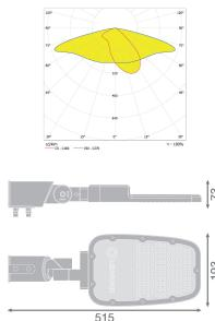
**Technische Daten Ledvance LED-Scheinwerfer Area mittel Grau 65W 8450lm 160x58D - 727 | IP66 - Symmetrisch**
