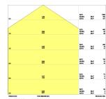
**Technische Daten Ledvance Surface Bulkhead 300 15W 840 1400lm Schwarz IP65 | Notbeleuchtung 3H**
